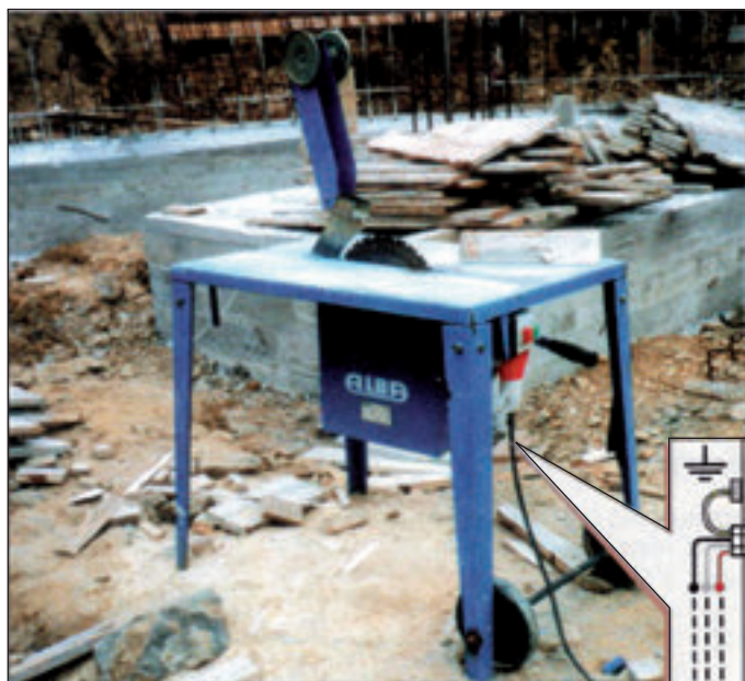
Figura 2. Receptor de la Clase I. Localización de conductor de protección verde/amarillo.
