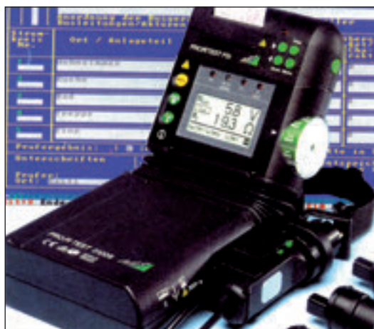
Figura 10. Equipo para la verificación de la intensidad de disparo de un interruptor diferencial. Indica además, la tensión, la intensidad de cortocircuito, valor de la resistencia de tierra, tiempo empleado en el disparo del diferencial y la tensión de defecto.
