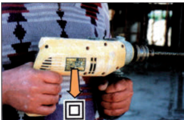
Figura 3. Herramienta portátil Clase II, de doble aislamiento. El símbolo de doble aislamiento debe ir marcado en la carcasa.
