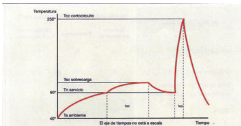
Figura 16. Gráfico de temperaturas máximas en un conductor.
