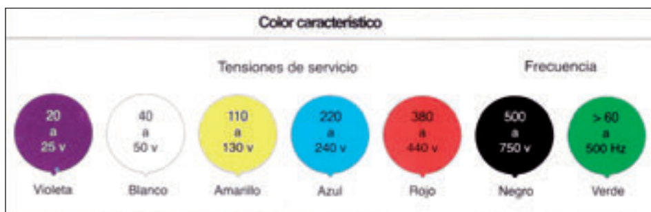
Figura 8. Colores normalizados para tomas de corriente (C.E.E.).
