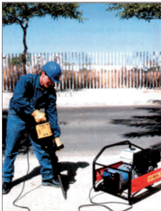
Figura 6. Receptores de doble aislamiento, alimentados con separación de circuitos.
