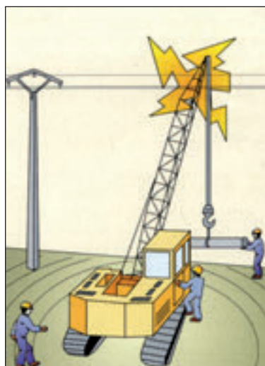
Figura. 2. Contacto de la pluma de una grúa con la línea eléctrica
