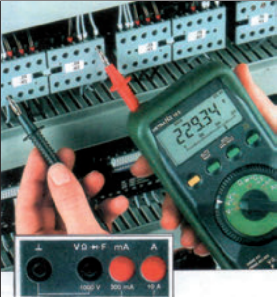
Figura. 6. Equipos de medida. El bloqueo automático de bornas (ABS) impide la corrección errónea.
