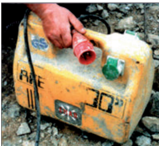
Figura 9. Vibrador eléctrico con toma de alimentación color rojo (380 V) y base de toma de corriente de salida de color verde (Frecuencia superior a 50 Hz; > 50 - 500 Hz).
