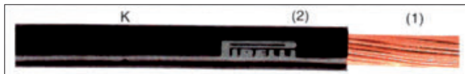
Figura 18. Cables formados por conductores (1) aislados y cubiertos por una mezcla especial a base de poliolefinas (2) tales que cuando arden emiten gases de muy reducida corrosividad y toxicidad, y casi totalmente transparentes los humos.
