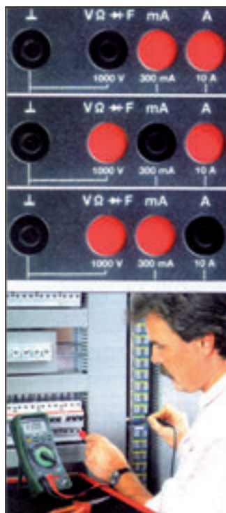
Figura 2. El bloqueo de las bornas impide la conexión errónea.
